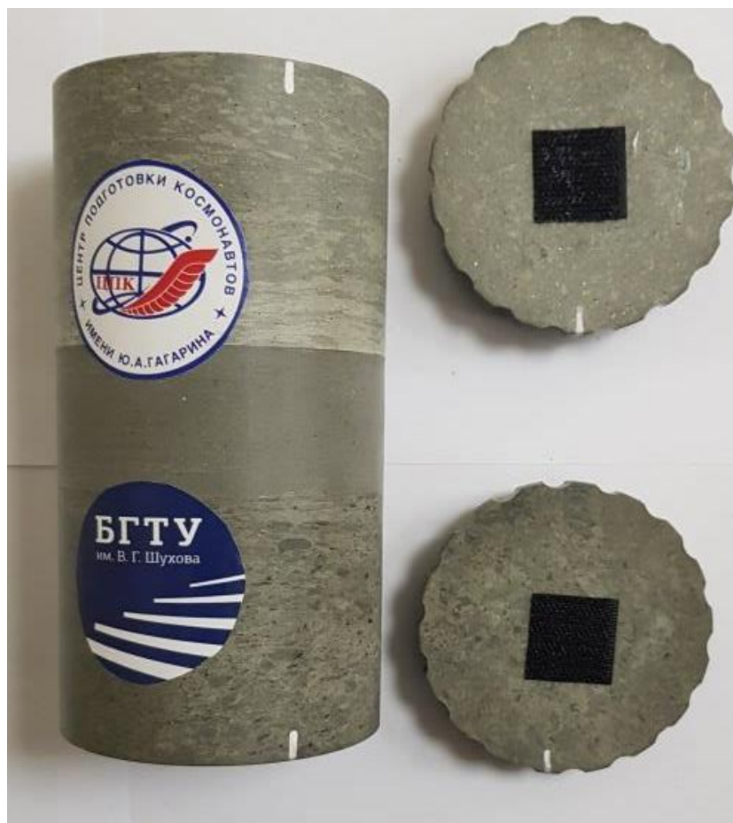
Фото контейнера из нового радиационно-защитного композита, разработанного Черкашиной Н.И. Контейнер подготовлен для отправки в космос
